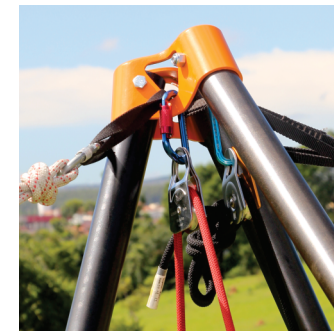
ESTABILIZAÇÃO ATRAVÉS DE FITAS CONECTADAS AO CABEÇOTE.
