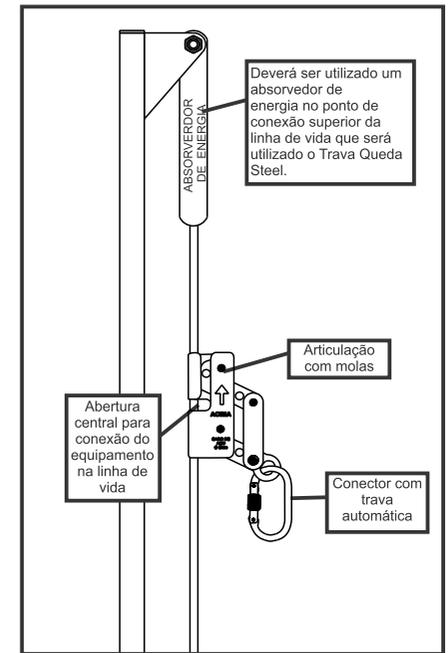
Conexão do trava quedas em ponto peitoral conforme indicado no manual dos cintos da linha TASK.
