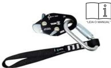
Dispositivo confeccionado em alumínio, fita confeccionada em poliéster e conector em aço com trava automática. Deve ser utilizado em linha flexível (poliamida), tipo A, com certificação EN 1891 e conforme NBR 15986 de 11 a 12mm de diâmetro em conjunto com o cinto de segurança tipo paraquedista.
